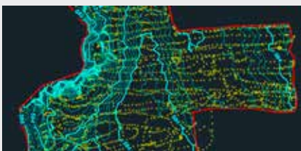
Messpunkte und Höhenkurven
